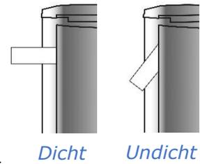
2. Eine Taschenlampe auf eine Ablage im Gerät stellen, Lichtschein in Richtung der Gerätetürdichtung ausrichten und Tür schließen. Scheint kein direktes Licht durch, ist die Gerätetürdichtung dicht.
